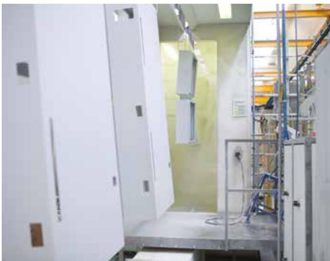
*La cabina di verniciatura a polvere robotizzata.*
