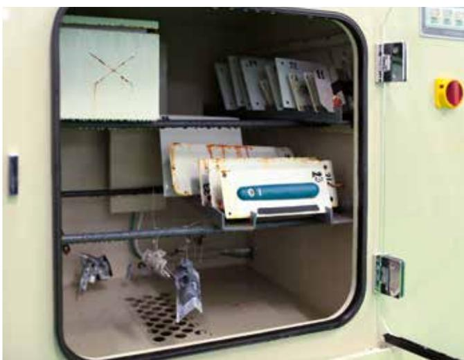
*Presso il centro di Ricerche ETA Next è installata la camera per la nebbia salina, al cui interno viene testata l'efficacia del trattamento E DUP.*
